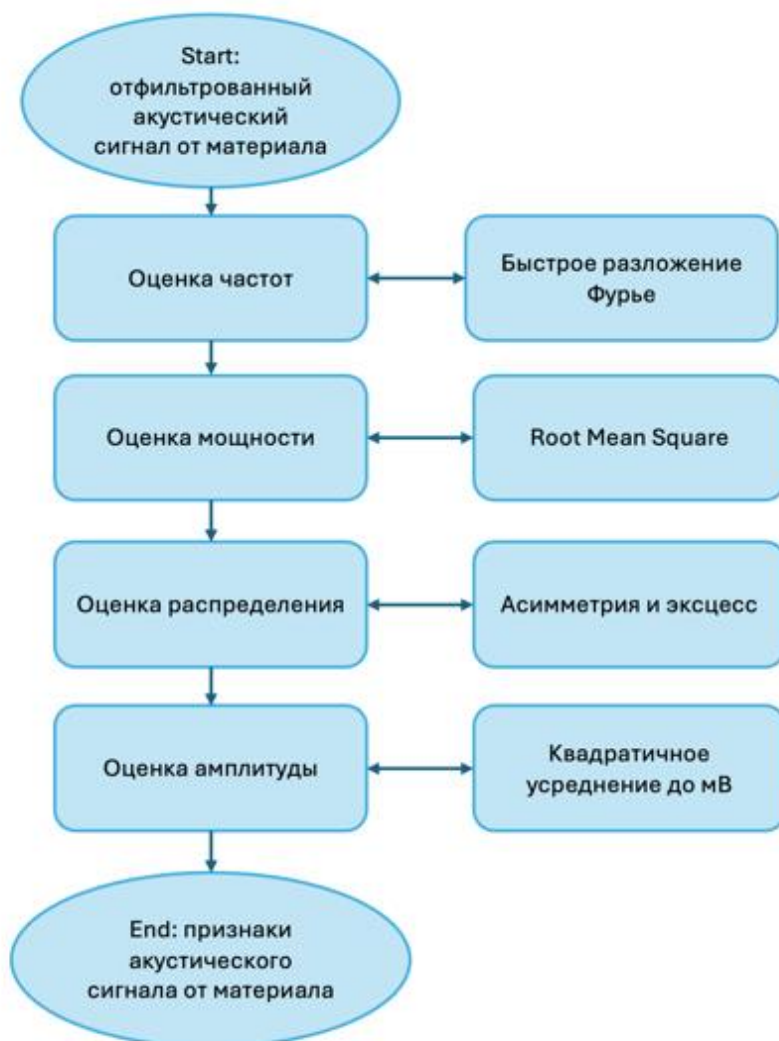
Рисунок 23 – алгоритм оценки параметров акустического сигнала
