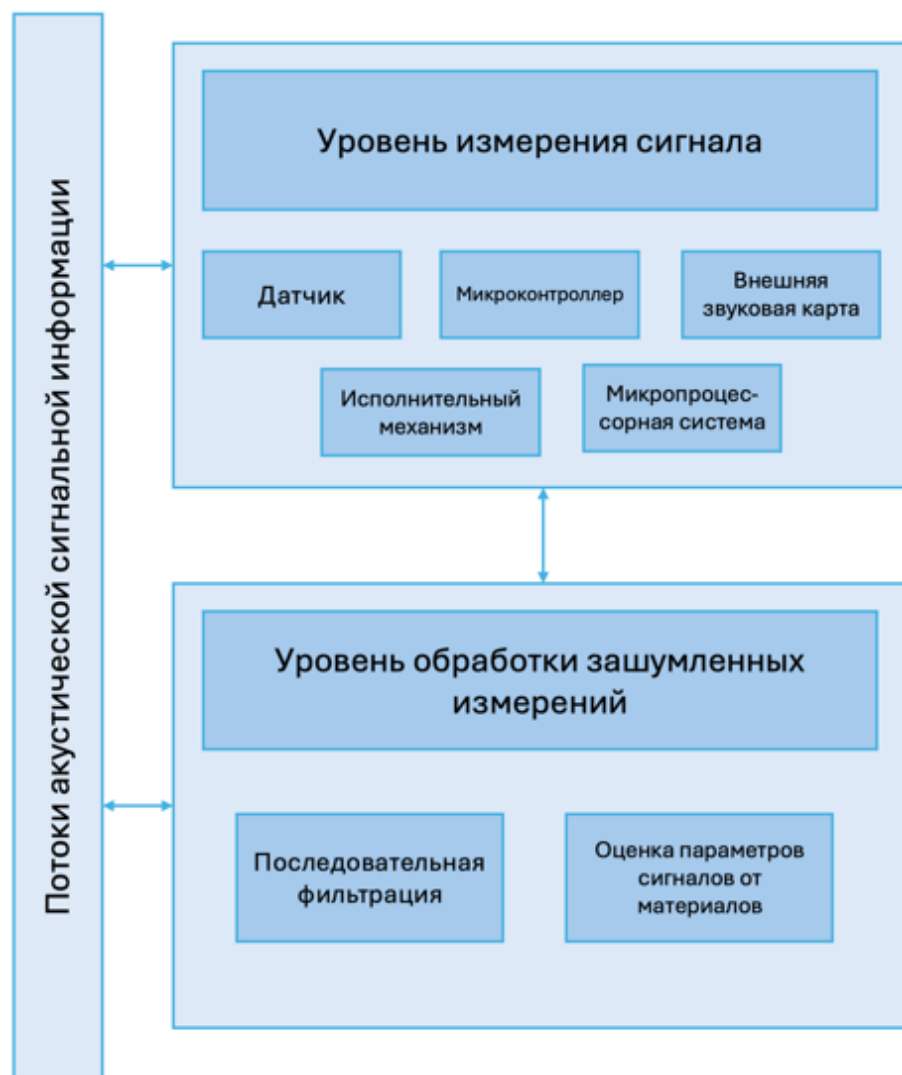
Рисунок 4 – архитектура системы регистрации акустических сигналов от материалов
